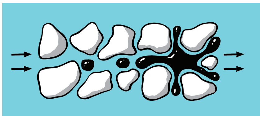
Een dwarsdoorsnede van een gesteente met een permeabiliteit waar olie doorheen kan stromen.
