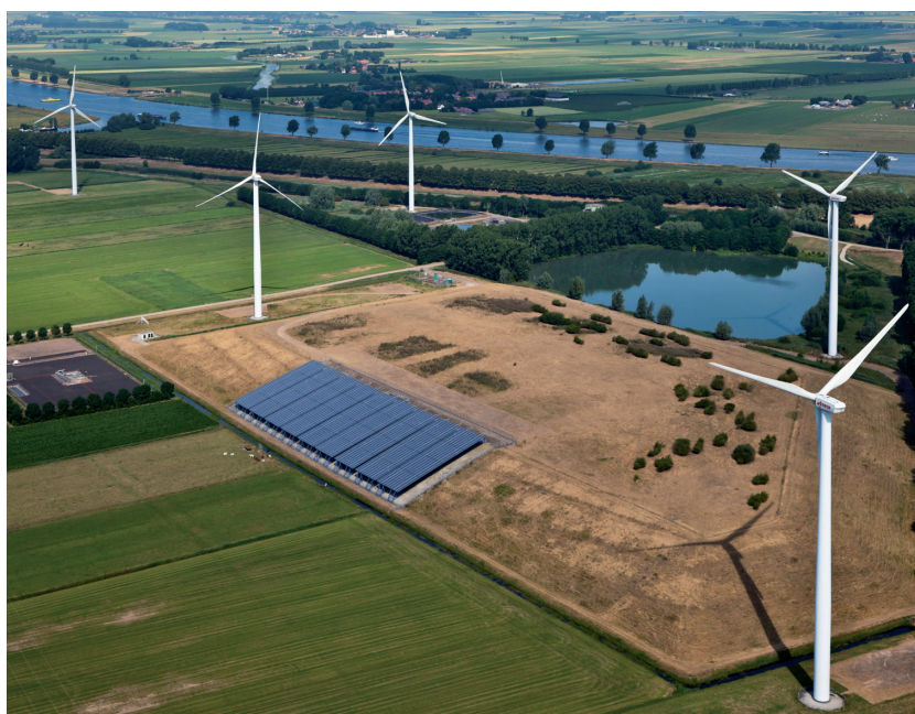
Beeld van het Ecopark Waalwijk, een voormalige stortplaats. In het park worden drie technologieën die bijdragen aan het afremmen van de groei van CO 2 gecombineerd: zonne-energie, windenergie en stortgas energie (biogas). Andere voorbeelden van innovatieve technologie die hieraan bijdragen zijn betere warmtewisselaars en warmte/koude opslag.
