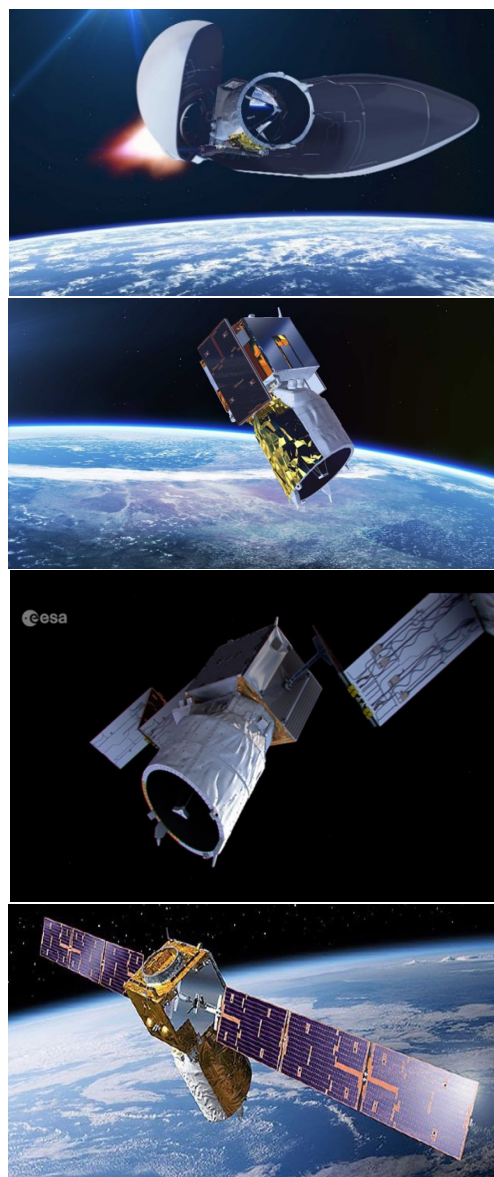
Figuur 7 Animatie van de lancering, het loskomen uit de laadruimte en het uitklappen van de AEOLUS. Bron: ESA
